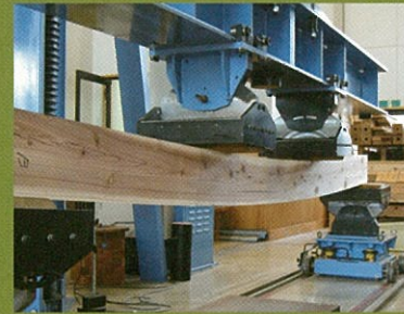
スギ平角の曲げ強度試験
